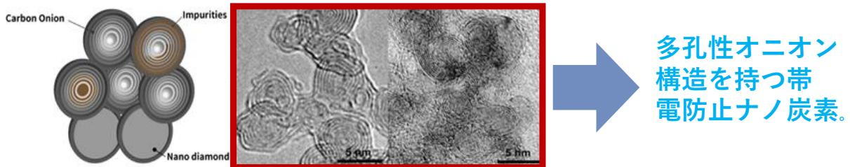
ネオモンドの帯電防止剤シリーズはネオモンドのリサイクル技術によって、廃棄されたナノ炭素から製造され、グレフェンまたはナノチューブで製造された帯電防止剤よりもコストパフォーマンスに優れています。添加製品に及ぼす影響を最小化しながら、添加量に比べ優れた帯電防止性能を提供します。
